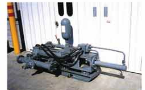
▲エアモルタルポンプ圧送
